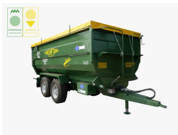
Fotografia 3.5 - Tipologia do contentor para colocação e transporte da fração sólida do digerido.
