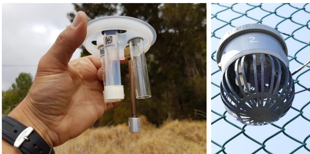
Fotografia 4.16 - Amostradores passivos usados na campanha de amostragem.
